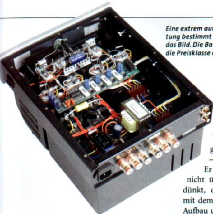
*Eine extrem aufgeräumte Freiverdrahtung bestimmt auch in der Endstufe das Bild. Die Bauteilequalität ist für die Preisklasse erstaunlich hoch*
