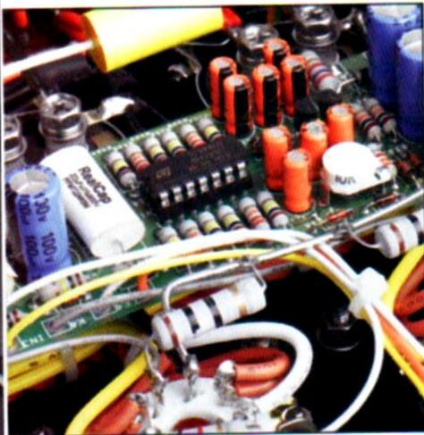
*Ein Hauch von Hightech: Die Operationsverstärker in diesem Chip besorgen die automatische Ruhestromeinstellung*
